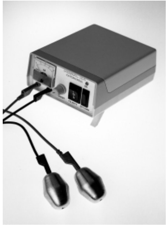
Kuva. Kotimainen akkuvirralla toimiva ja VTT:n hyväksymä iontoforeesilaitte hyperhidroosin hoitoon. Kuvassa näkyvät uudet kainalohikoilun hoitoon tarkoitetut palloelektrodit.
